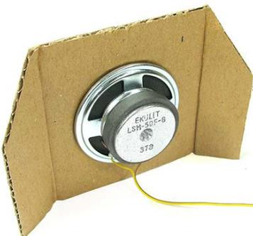
Le haut-parleur doit impérativement être monté sur un carton, une petite planche de bois, ou dans une boîte fermée afin d'éviter un court-circuit acoustique.
