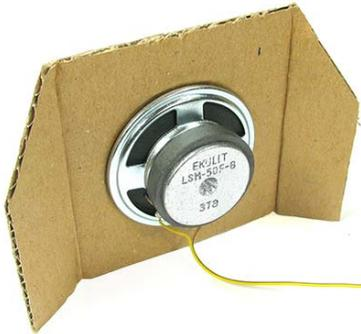
Le haut-parleur doit impérativement être monté sur un carton, une petite planche de bois, ou dans une boîte fermée afin d'éviter un court-circuit acoustique.
